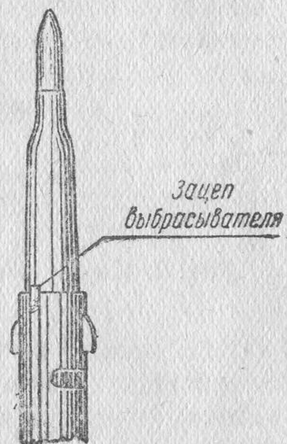
Рис. 13. Патрон находится в чашке боевой личинки. Зацеп выбрасывателя заскочил за край гильзы
