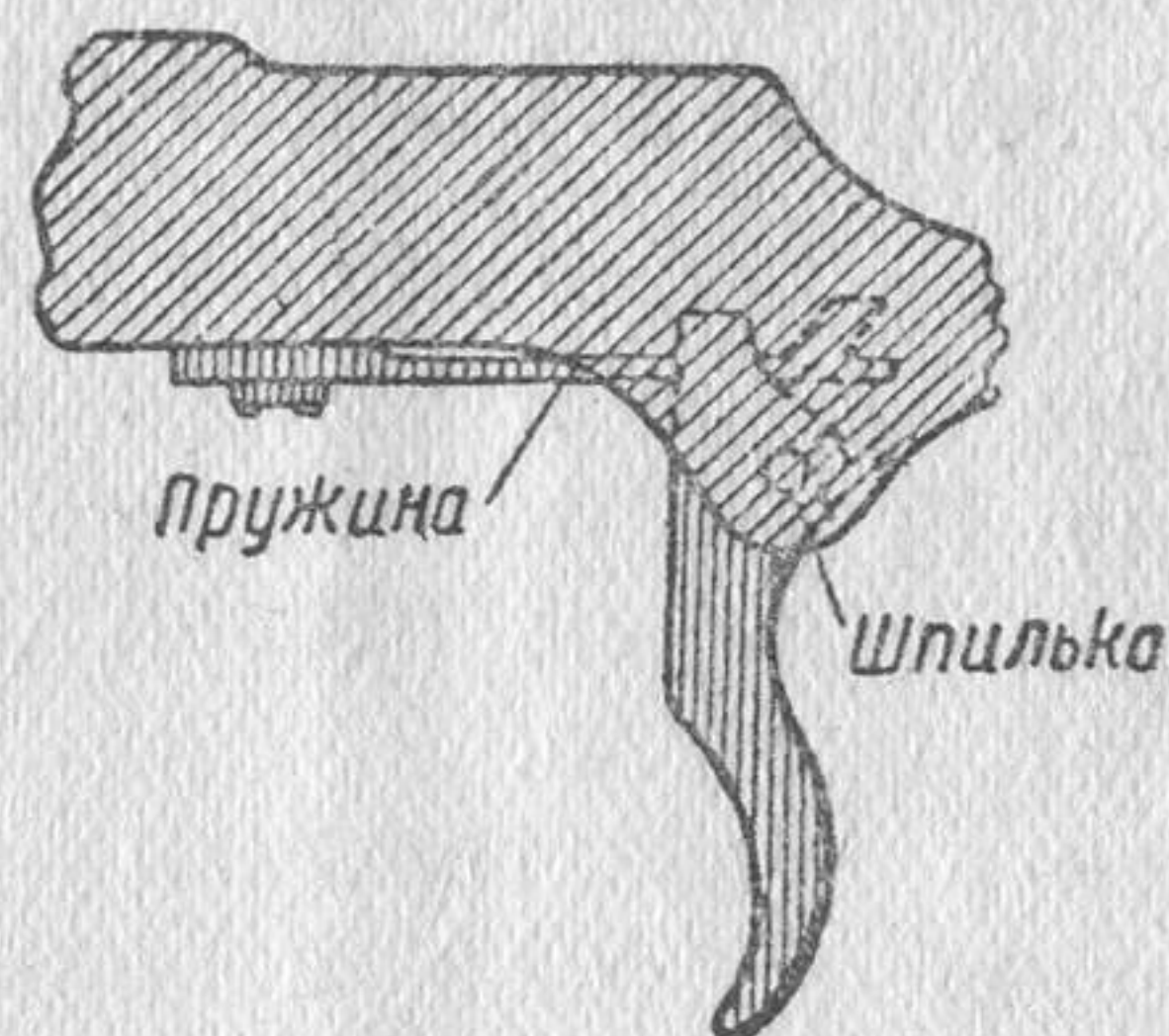
Рис. 16. Спусковой механизм укреплен между ушками ствольной коробки
