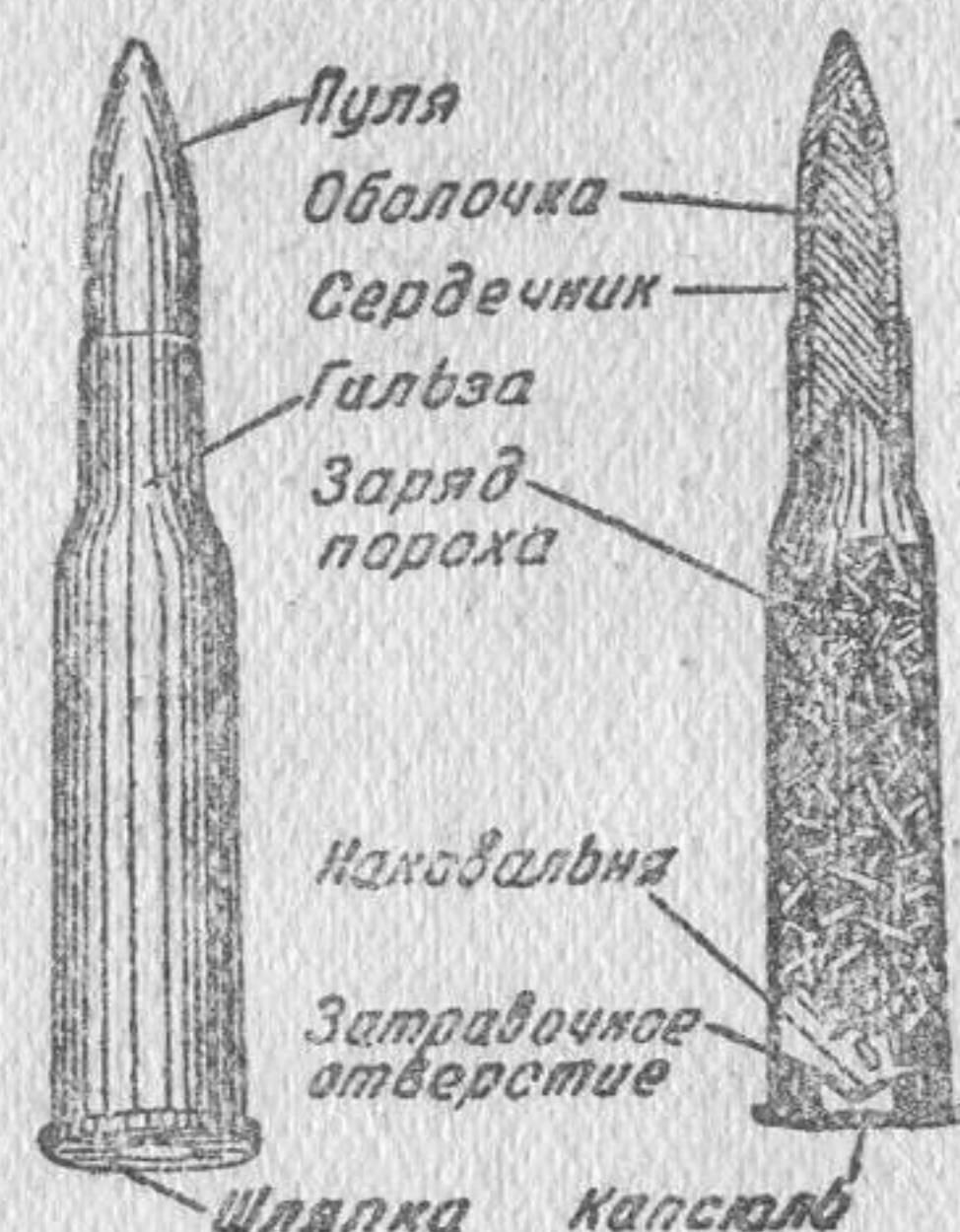
Рис. 3. Боевой патрон, общий вид и разрез
