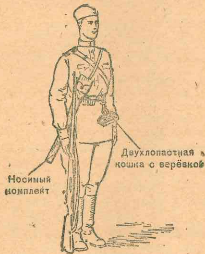
Рис. 117. Носимый комплект для разминирования КР, на бойце
