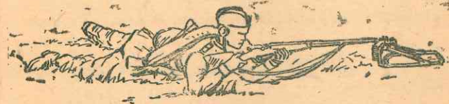
Рис. 115. Работа с миноискателем, установленным на винтовке, при переползании
