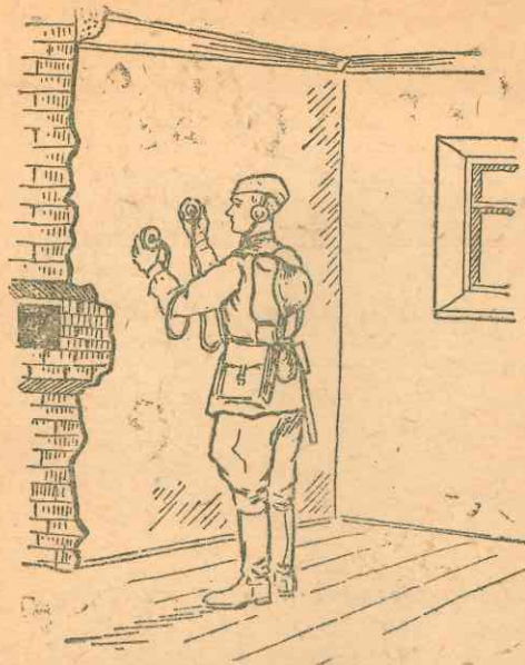
Рис. 134. Поиски мин с часовым замыкателем в каменной стене стетоскопом
