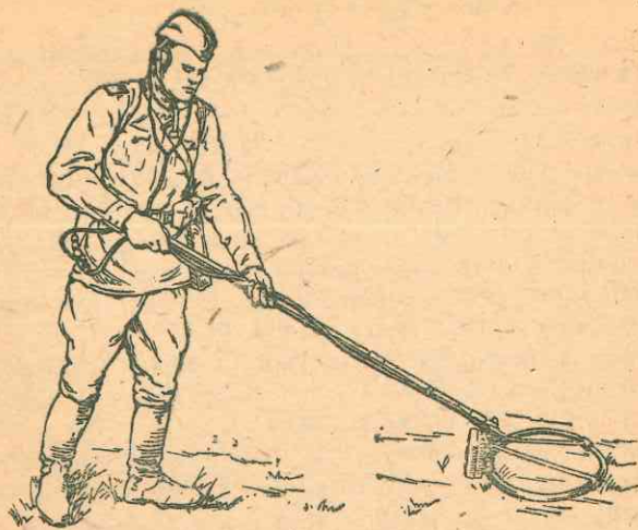
Рис. 116. Работа с миноискателем, укрепленным на штанге
