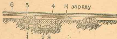
Рис. 14. Установка вибрационного замыкателя ВЗ-1 под шпалой:
