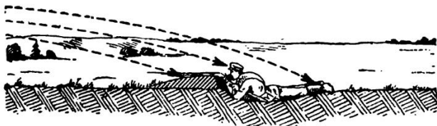
Рис. 36. В окопе для стрельбы лежа поражаемая площадь шрапнелью и пулями равна 20 \text{ м} \times 50 \text{ м} .
