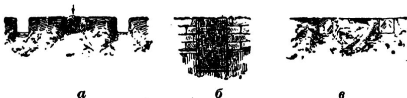
Рис. 26. Особенно надо уметь маскировать бойницы. Незамаскированная бойница помогает противнику обнаружить занявшего ее стрелка а . Мешок или портянка, подвешенные сзади бойницы б , сделают бойницу и стрелка невидимыми со стороны противника в .
